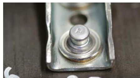
Po celém obvodu jasně viditelný otisk pístu na vrchní podložce hřebu X-ENP 21 HVB
