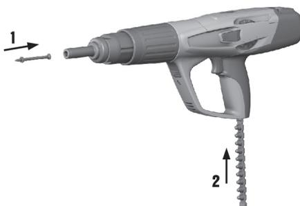
1. Introduzca el elemento de fijación en la herramienta desde delante hasta que la arandela del elemento de fijación quede sujeta en la herramienta.
