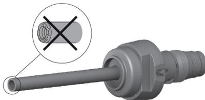
1. Compruebe el desgaste que presenta el guía clavos y sustitúyalo cuando el segmento del guía clavos esté dañado (p. ej. roto, retorcido, abocardado, con fisuras, etc.).
