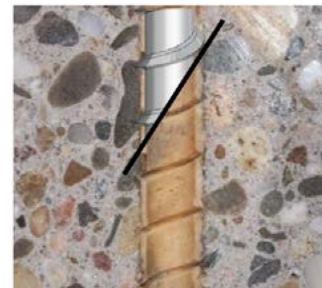
Řez kotevním otvorem při použití kapsle HUS4-MAX.
